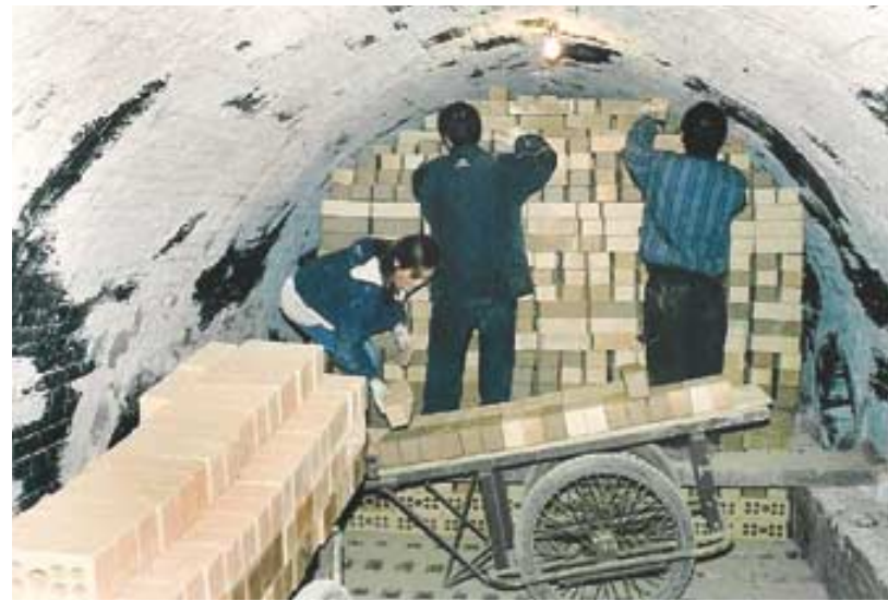
단기마에서 1200℃의 온도로 구운 뒤 서서히 식혀야 냉파 등 결함이 없는 전돌을 얻을 수 있다. 동희산업 근로자들이 단기마에서 점토로 빚은 전돌을 쌓는 모습.
