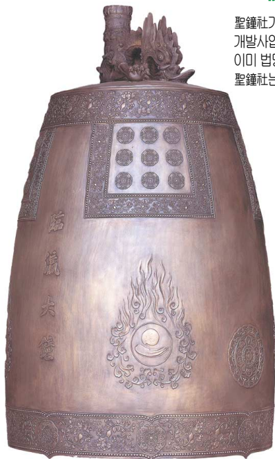
밀랍주조공법으로 제작된 강릉시민의 종 높이 3.15m, 직경 1.85m 중량 3000kg
