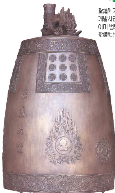
밀랍주조공법으로 제작된 강릉시민의 종 높이 3.15m, 직경 1.85m 중량 3000만
