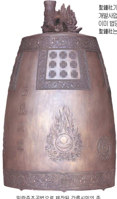
밀랍주조공법으로 제작된 강릉시민의 종 높이 3.15m, 직경 1.85m, 중량 3000kg
