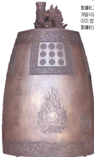
밀랍주조공법으로 제작된 강릉시민의 종 높이 3.15m, 직경 1.85m 중량 3000관
