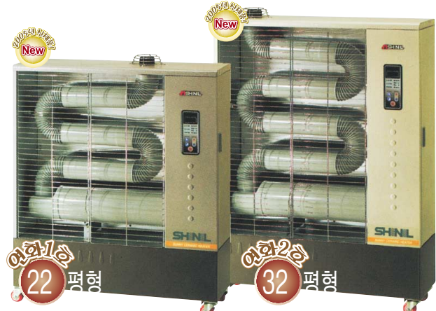
SBH-011 TSI 소비자가: W850,000 특별보급가: W690,000 ● 발열량: 10,000Kcal/h ● 탱크용량: 45ℓ ● 연료소비량: 1.02~1.35ℓ/h ● 외형치수: 950×305×1,180mm ● 자동확인 LCD창 · 리모콘 조절 ● 사용전원: 220V 60Hz ● 미니소음기 및 연통
