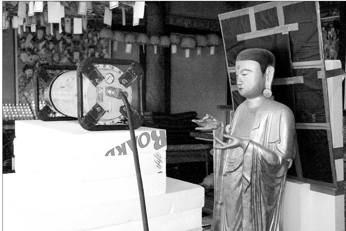
서산 개심사 대웅보전 지장보살상의 X레이 촬영 장면. 왼쪽의 기구는 X레이 발생장치며 그 아래 스티로폼들은 높이조절을 위한 것이다.
