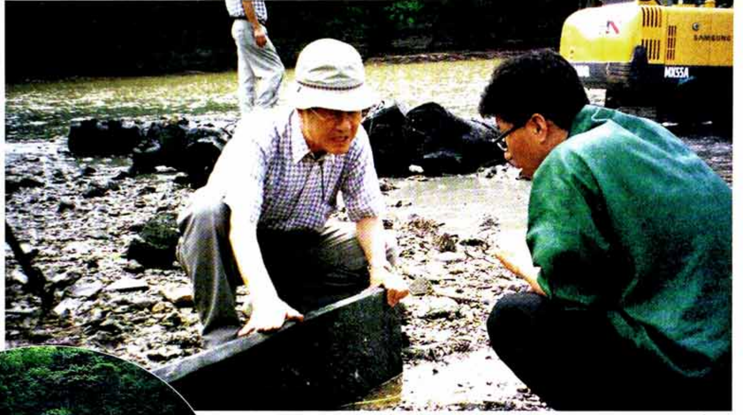
◀경북대 박상진교수(사진 왼쪽)는 '대장경판용 목재는 통나무 상태가 아닌, 판재로 가공한 것을 바다에 넣었을 것으로 추정하고 있다. 이에 따라 대장경문화학교가 3년간 침수시킨 목재에는 원목 외에도 실험용 판재 등이 섞여있다.
