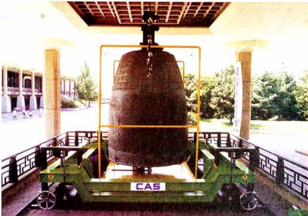
◇성덕대왕신종이 소리를 멈춘지 6년4개월, 종은 울림 때문이 생명력을 발휘한다는 주장과 영구보존을 위해 타종을 금지해야 한다는 주장이 팽팽히 맞서고 있다. 사진은 96년부터 시작된 신종에 대한 종합안전진단 중 중랑을 측정하고 실측하는 장면. 종의 무게는 18.9톤, 높이는 3.64m로 실측됐다.
